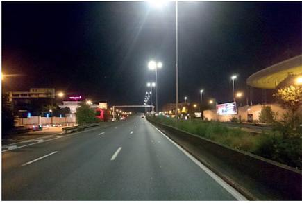
Depuis 2015, LA DiRIF modernise l'éclairage public de l'autoroute A1 entre la porte de La Chapelle et l'aéroport de Paris-Charles-de-Gaulle, notamment en remplaçant des lampes à sodium par des nouveaux luminaires LED. L'éclairage LED mis en œuvre offre une meilleure qualité d'éclairage, permet d'en contrôler la gradation pour l'adapter au contexte, tout en **réduisant significativement la consommation d'énergie (de l'ordre de 60%)** et donc les coûts en alimentation électrique.
